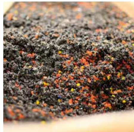
Granulat från PUR-spill som kan användas till nya produkter
